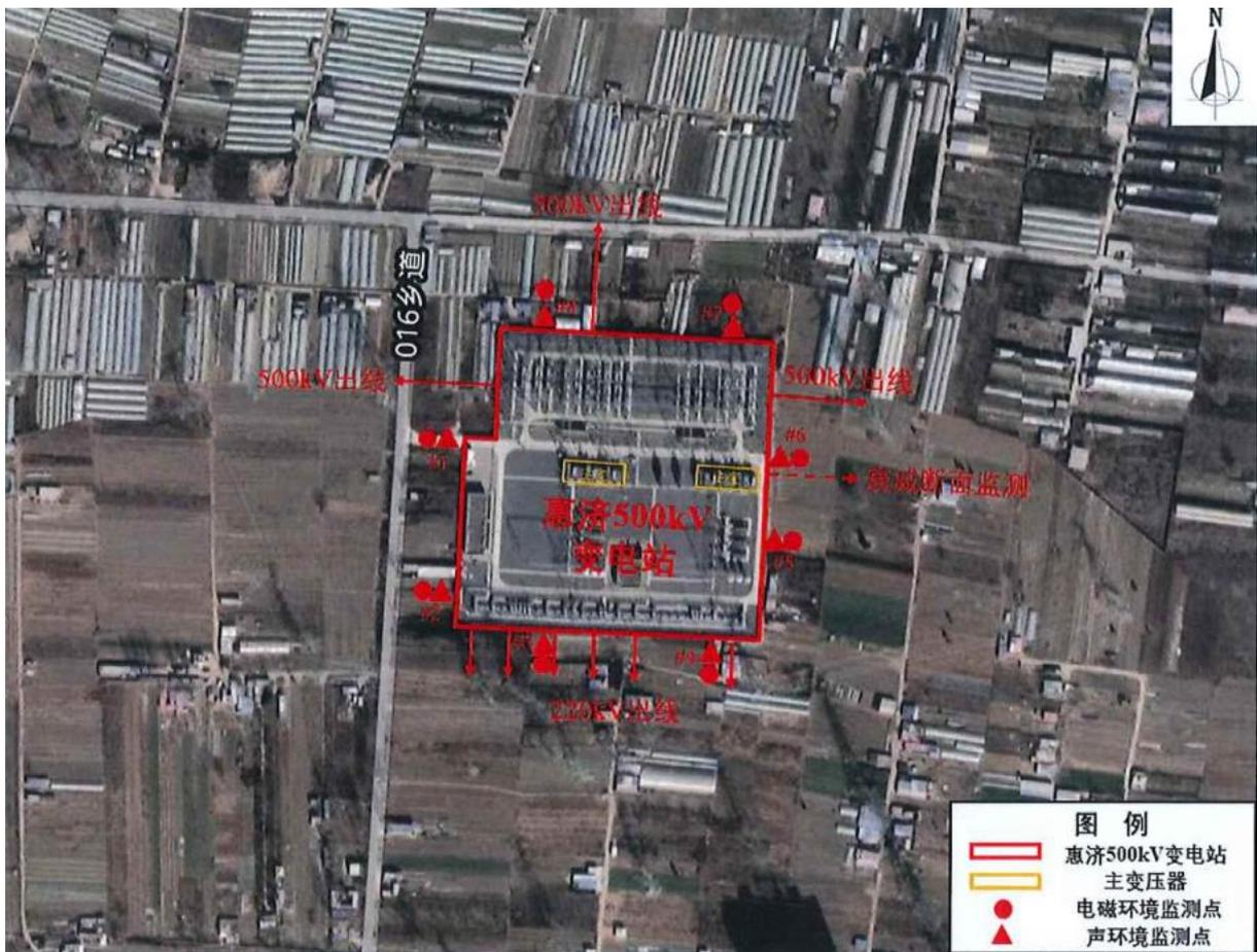
图 6-2 惠济 500kV 变电站监测点位图
